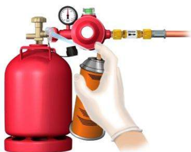
Abbildung 7: Dichtheitskontrolle unter Druck mittels Lecksuchspray
